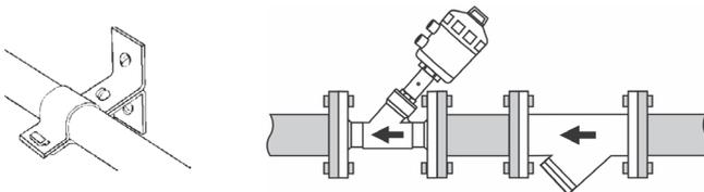
7. Трубопровод и клапан проверьте на соосность.
